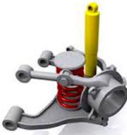
Это значит, что каждое отдельное колесо воспринимает ямы и бугры независимо от остальных, что позволяет сохранять максимально вертикальное отношение к дорожному покрытию и оптимальное сцепление покрышки с поверхностью дороги.
